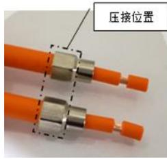
图 8 屏蔽环压接示意图
